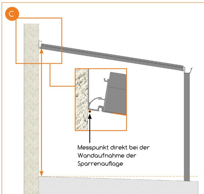
Messpunkt direkt bei der Wandaufnahme der Sparrenauflage
