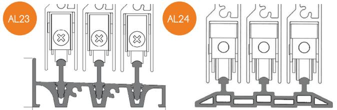
Abbildungen dienen zur Auswahl des Laufschienentyps
